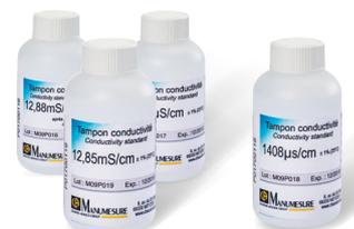
Afin de vérifier que la constante de cellule donnée par le fabricant est toujours valable, il faut étalonner son conductimètre avant d'effectuer toutes mesures. Pour ce faire, il faut réaliser l'étalonnage avec des solutions étalons, dans les mêmes conditions que celles rencontrées durant la mesure (température, plage de mesure, agitation, solvant...).
