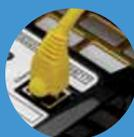
Une sortie Ethernet (Modbus TCP)
